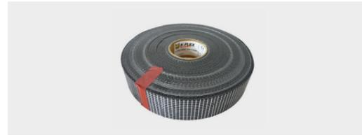
La bande K-FIRE SEALSTRIP est livrée en rouleau continu, prête à découper à la bonne longueur pendant l'installation. En cas d'incendie, le matériau intumescent contenu dans la bande s'expande et écrase le tube plastique en bouchant l'espace creux. Ceci permet de restaurer les propriétés coupe-feu du mur ou du plancher.
