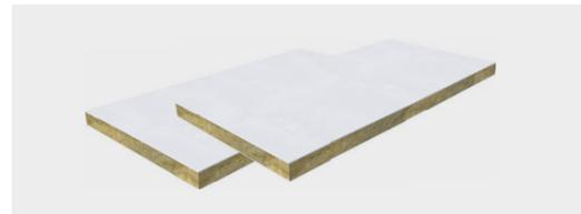
K-FIRE BATT est une plaque de laine minérale enduite (140 kg/m<sup>3</sup>) permettant de restaurer les performances coupe-feu des murs aux emplacements où ils sont traversés par des pénétrations de service. K-FIRE BATT associé au K-FIRE SEALANT A sont conçus pour prévenir le passage de feu et fumées tout en permettant l'installation des éléments de service.
