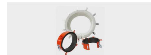
K-FIRE COLLAR est une gamme complète destinée aux tubes plastiques traversant des structures coupe-feu. En cas d'incendie, la matière intumescente contenue à l'intérieur du collier, gonfle et écrase le tube plastique dégradé sous l'effet de la chaleur. L'intégrité du mur ou plancher coupe-feu est ainsi rétablie.
